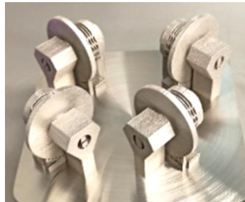
Hélicoptère Bell 429 (gauche), embrayages MR imprimés 3D (centre), actionneur MR intégré (droite)
