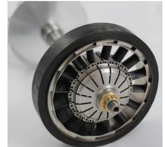
Turbine renversée avec pales en céramique
