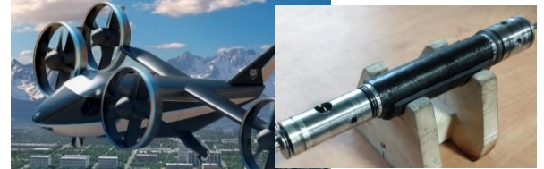
Bell NEXUS et rotor de la première génération de machine électrique haute-vitesse
