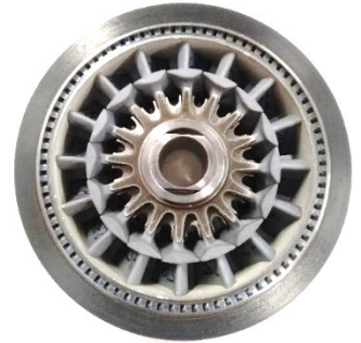
Turbine renversée avec pales en céramique
